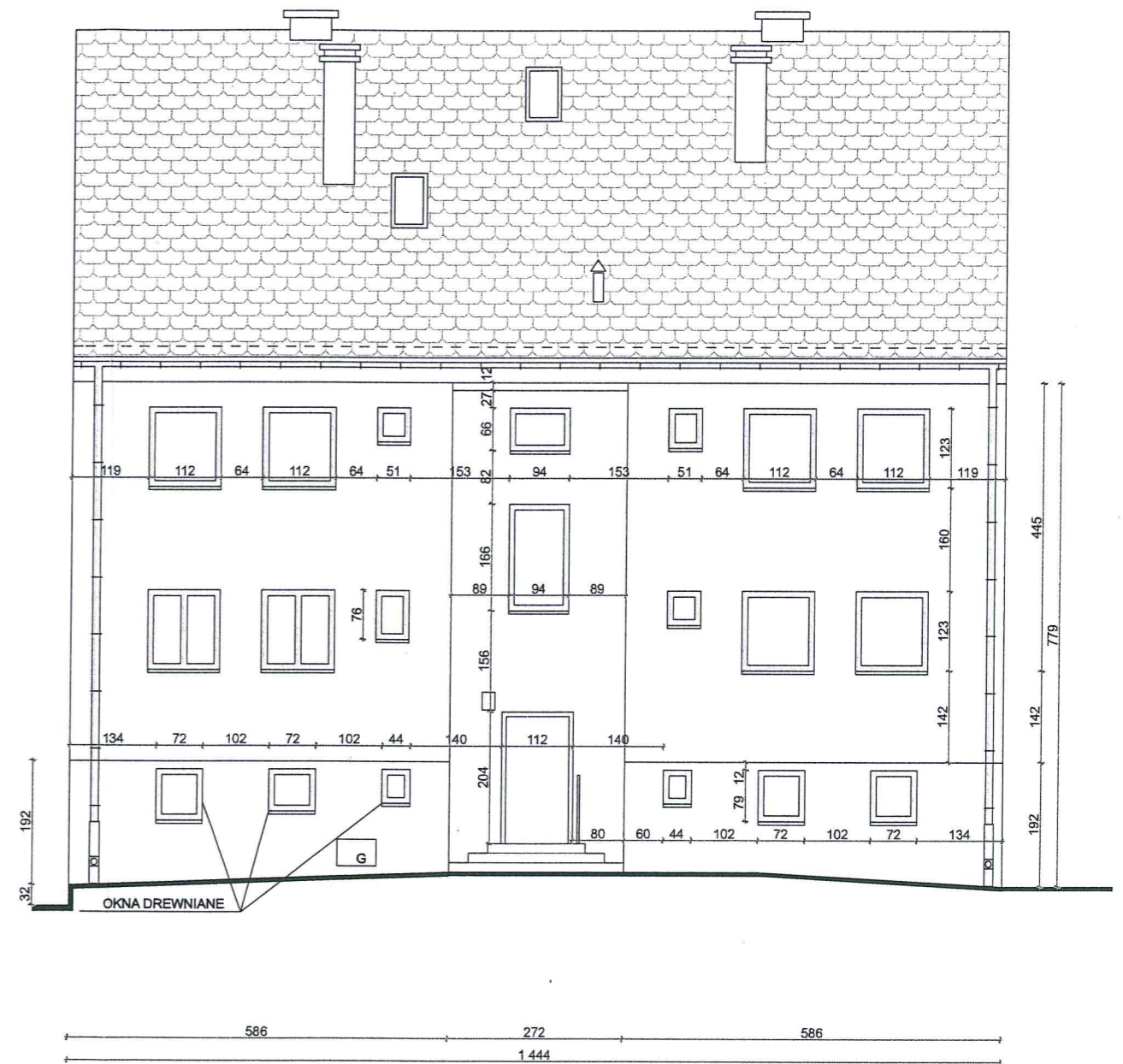
ELEWACJA PÓŁNOCNA - FRONTOWA
