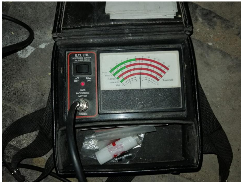
Fot. 5 Pomiar wilgotności przegrody budowlanej z widocznym wynikiem
