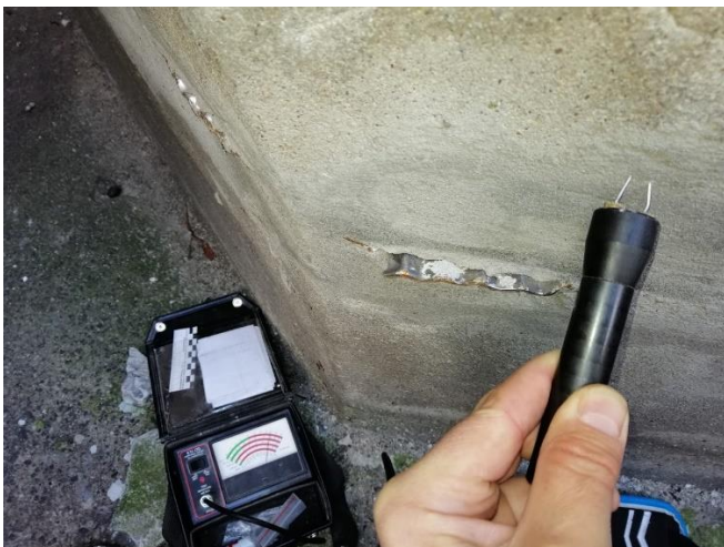
Fot. 6 pomiar wilgotności nad blachą
