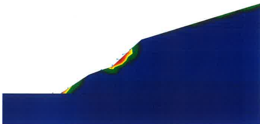
Rys 1. Obliczenia stateczności metodą SSRM, współczynnik bezpieczeństwa FS 0,90
